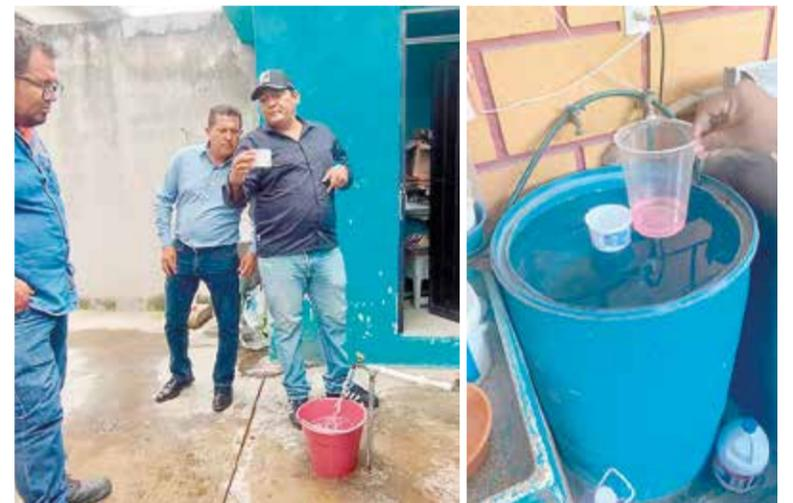
muestreos en la red de distribución de agua potable, verificando la concentración de cloro residual libre y confirmando que el agua es potable y libre de contaminación.
